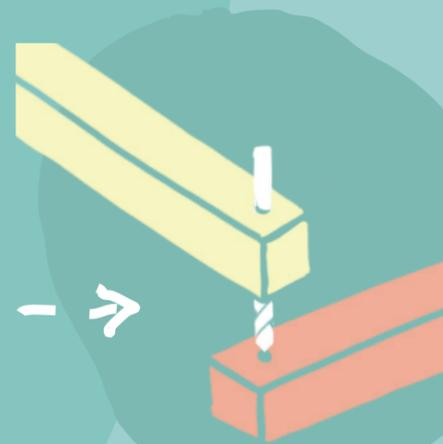
4. Anschließend verbindet ihr je zwei **Stützbalken** mit einem **Querbalken** und erhaltet so zwei U-förmige Rahmen. Schraubt sie gut fest, damit sie sich nicht lösen.
