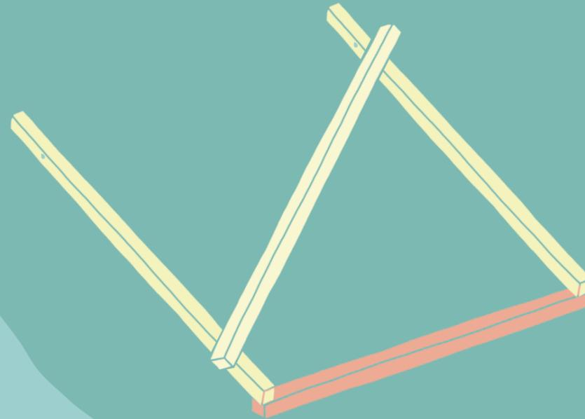
Haltet ihn gut fest, während Mama oder Papa wieder die Löcher vorbohrt. Dazu bohrt ihr den oberen Balken durch und reißt auf dem unteren das Loch an. Anschließend schraubt ihr den Balken am Rahmen fest. Verfahrt mit dem letzten **Stützbalken** und dem zweiten U auf die gleiche Weise.
